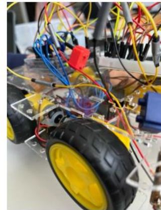
Abbildung 11: Einbau und Verkabelung der LED's
