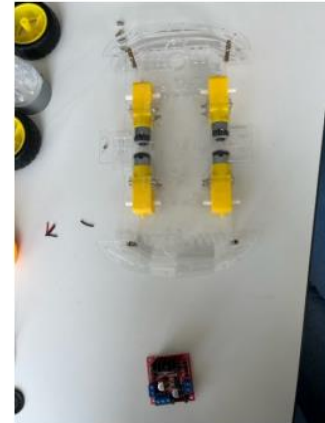
Abbildung 7: Zusammenbau der Radmotoren und der H-Brücke
