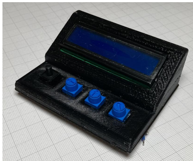
Bild 6: Gehäuse der Bedieneinheit (links, STL-Modell) und fertig mit LCD und Arduino Shield (rechts)
