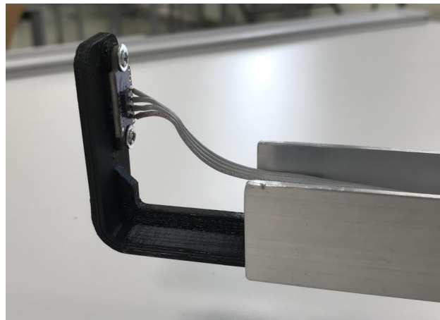
Bild 5: Befestigung des ToF-Sensors - Konstruktion in FreeCAD (links), fertig gedruckt und montiert (rechts)
