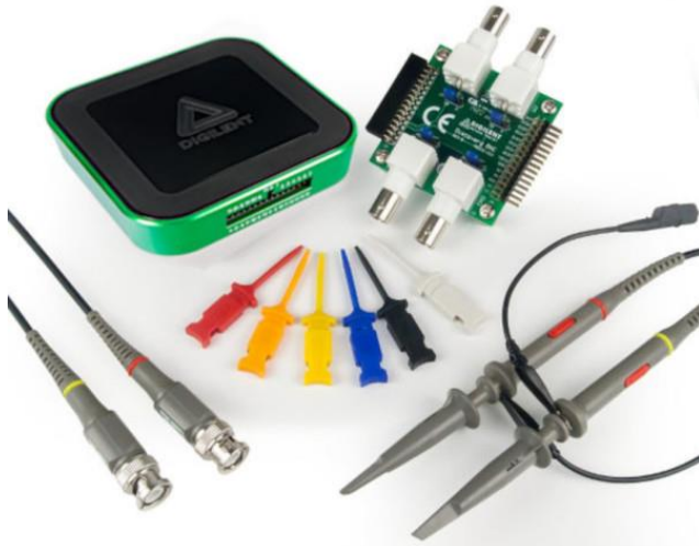
Bild 11: USB-Digital Speicheroszilloskop und Signalgenerator mit Tastköpfen und Zubehör
