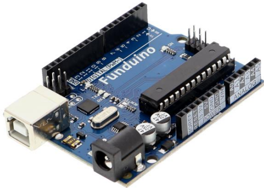
Bild 7: Mikrocontrollerboard kompatibel zu Arduino UNO R3
